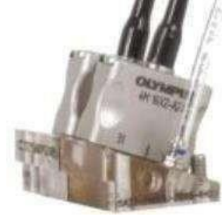
A27 (DMA) Probewith AOD wedges
